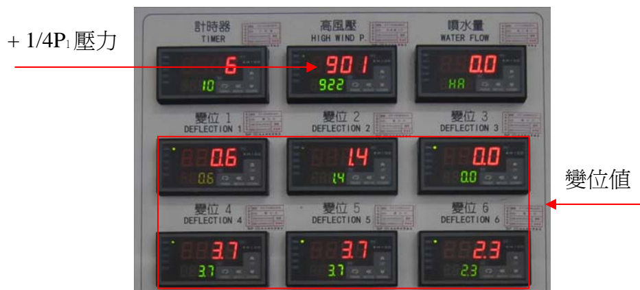
正風壓試驗情形 3600 Pa
